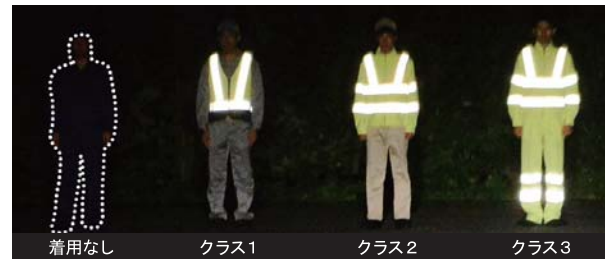
150m先の被写体を撮影した映像を画像化
